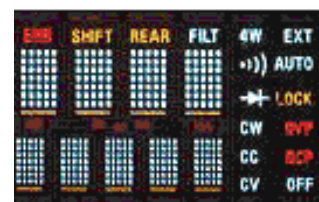
3-х цветный двухстрочный дисплей на базе VDF матриц (B7-78/1)
