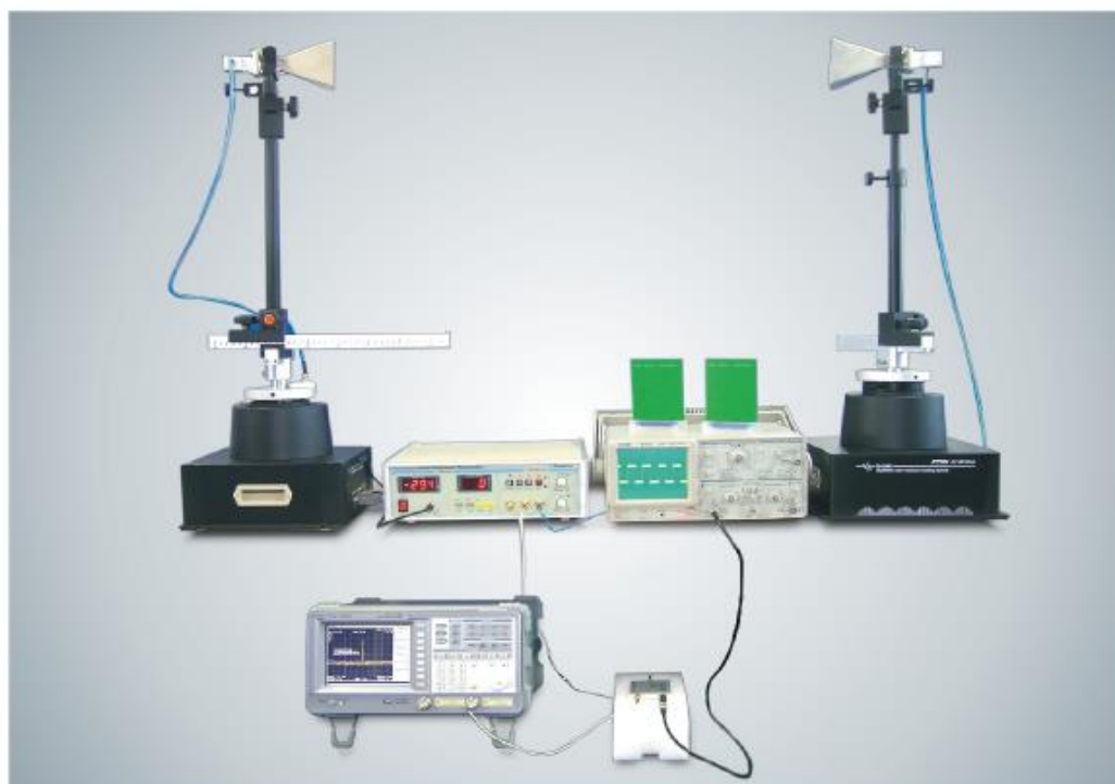
Типовая схема подключения элементов обучающего комплекса (антенны, устр-ва юстировки, кабели, контроллер-измеритель) и внешних средств измерений (анализатор спектра, осциллограф) для выполнения практических опытов
